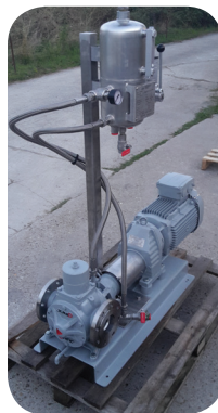
Groupe JV40s avec pot de lubrification
